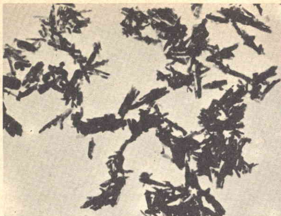
Questa fotografia al microscopio elettronico di un pezzo di nastro audio mostra le particelle di ossido. L'ingrandimento è di 60.000 volte.
